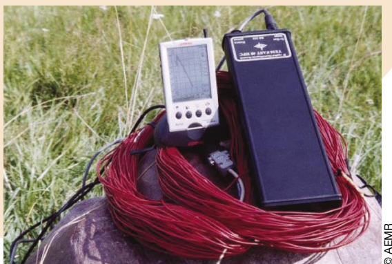
Figure 2.1 - TEM-Fast 48HPC (AEMR), avec le PC de poche et le câble permettant de construire le dispositif de mesure.
