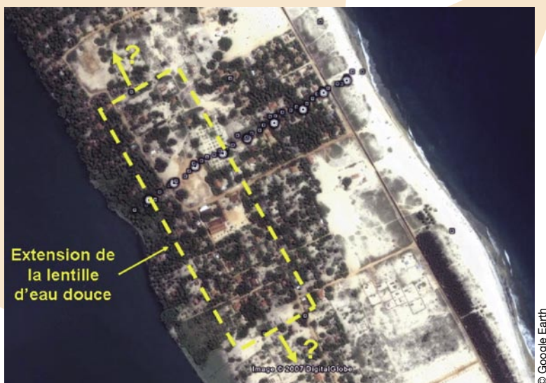
Figure 3.7 - Première estimation de l'extension de la lentille d'eau douce à Navalady au bout de deux jours de prospection TDEM.
